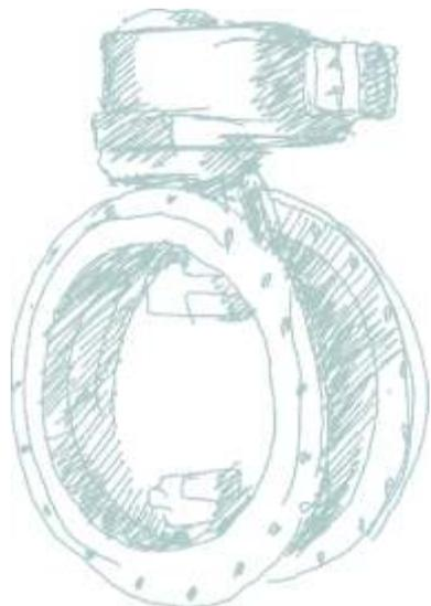
**Пример:** Затвор дисковый запорно–регулирующий DN 500 PN 1,0 МПа из чугуна СЧ20, фланцевое присоединение с электроприводом для рабочей среды «вода» с температурой до +100 °С, класс герметичности D, соответствует обозначению: Затвор K3 99167–500 PN 1,0 МПа исполнение: А69 В51 С01 D09 Е01 F02 У3 D.
