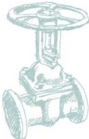
Пример: Задвижка клиновая с жестким клином DN 50 PN 4,0П МПа ХЛ1 из стали ХМ25Л, фланцевая, с ручным управлением, для рабочей среды «жидкие и газообразные нефтепродукты» с температурой до +425 °С, класс герметичности А, соответствует обозначению: Задвижка ЗКЛ 13004-050 PN 4,0 МПа исполнение: А11 В04 С01 D00 Е05 F11 ХЛ1 А.
