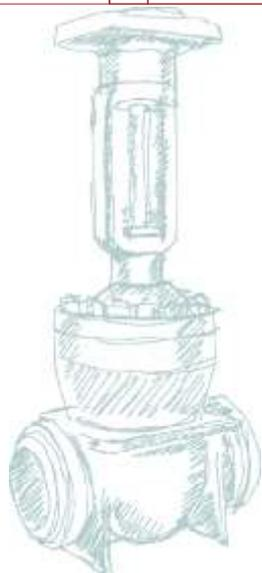
**Пример:** Задвижка клиновая с выдвигаемым шпинделем DN 150 PN 16,0 МПа ХЛ1 из стали ХМ25Л, с патрубками под приварку встык, электрический привод, для рабочей среды «газообразные нефтепродукты» с температурой до +120 °С, класс герметичности А, соответствует обозначению: Задвижка К3 11005-150 PN 16,0 МПа исполнение: А11 В04 С16 D09 Е05 F04 ХЛ1 А.
