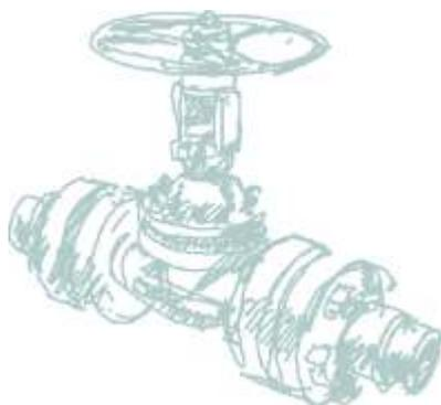
Пример: Задвижка клиновая с жестким клином DN 100 PN 25,0 МПа ХЛ1 из стали 09Г2С, соединение фланцевое, с ручным управлением, для рабочей среды «жидкие и газообразные нефтепродукты» с температурой до +200 °С, класс герметичности А, соответствует обозначению: Задвижка КЗ 11012-100 PN 25,0 МПа исполнение: А11 В02 С11 D00 Е05 F05 ХЛ1 А.
