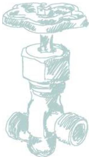
Пример: Клапан запорный проходной DN 10 PN 2,5 МПа ХЛ1 из стали 20ХН3А с цапковым присоединением, с ручным управлением, для рабочей среды «жидкий и газообразный аммиак» с температурой от минус 70 °С до +150°С, класс герметичности А, соответствует обозначению: Клапан запорный К3 22043.010М PN 2,5 МПа исполнение: А22 В05 С51 D00 Е21 F33 ХЛ1 А.
