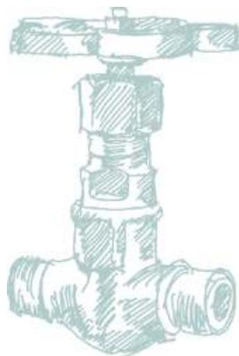
**Пример:** Клапан регулирующий проходной DN 15 PN 2,5 МПа, У1 из стали 25, присоединение цапковое с наружной резьбой, с ручным управлением, для рабочей среды «жидкий и газообразный аммиак» с температурой от минус 40 °С до +150 °С, соответствует обозначению:
