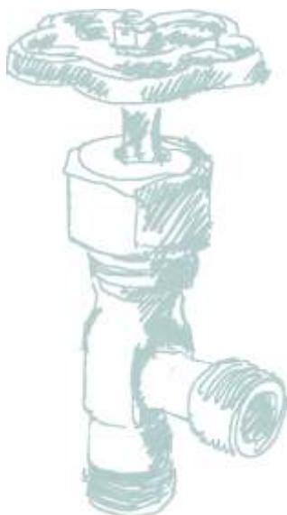
**Пример:** Клапан запорный угловой DN 10 PN 2,5 МПа ХЛ1 из стали 20ХН3А с штуцерно-торцевым цапковым присоединением, с ручным управлением, для рабочей среды «жидкий и газообразный аммиак» с температурой от минус 70 °С до +150°С, класс герметичности А, соответствует обозначению: Клапан запорный К3 24028-010 PN 2,5 МПа исполнение: А22 В05 С01 D00 Е21 F34 ХЛ1 А.
