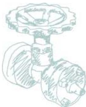
**Пример:** Клапан запорный проходной DN 15 PN 16,0 МПа ХЛ1 из стали 09Г2С, под приварку встык, с ручным управлением, для рабочей среды «газообразные нефтепродукты» с температурой до 425 °С, класс герметичности А, соответствует обозначению: Клапан КЗ 21216-015 PN 16,0 МПа исполнение: А21 В02 С16 D00 E05 F11 ХЛ1 А.
