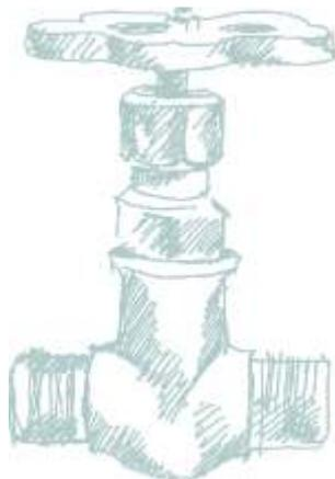
**Пример:** Клапан запорный проходной DN 10 PN 10,0 МПа, У1 из стали 09Г2С, цапковый с наружной резьбой, с ручным управлением, для рабочей среды «углекислота» с температурой от минус 80 °С до +150 °С, класс герметичности А, соответствует обозначению: Клапан запорный проходной КЗ 22004-010 PN 10,0 МПа исполнение: А22 В02 С51 D00 Е31 F34 У1 А.
